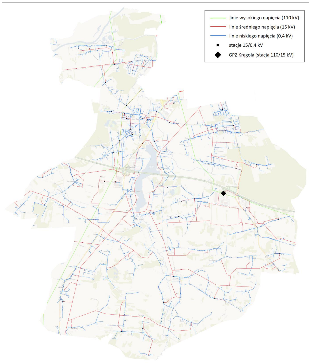
Rysunek 4. Schemat dystrybucyjnego systemu elektroenergetycznego ENERGA-OPERATOR S.A. na terenie gminy Stare Miasto
